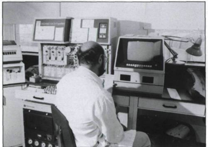
L'utilisation du Technicon HI dans le laboratoire d'hématologie permet une analyse rapide du sang et sans risque de contagion pour le technicien. (Photographie médicale, Hôtel-Dieu de Québec).
